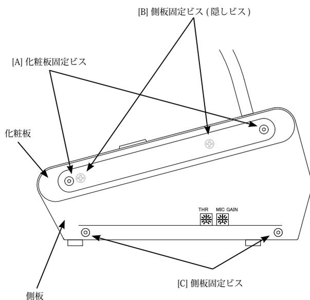
マイクアンプのゲイン調整およびコンプレッサーのスレッシュホールド調整は、本機右側の側板を開けて行います。必ず TB-31 の電源を切り、本機が動作しない状態で作業を行って下さい。
